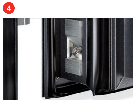
Stabile Eckverbindungen Profile auf Gehrung verschraubt, verklebt und verbolzt
